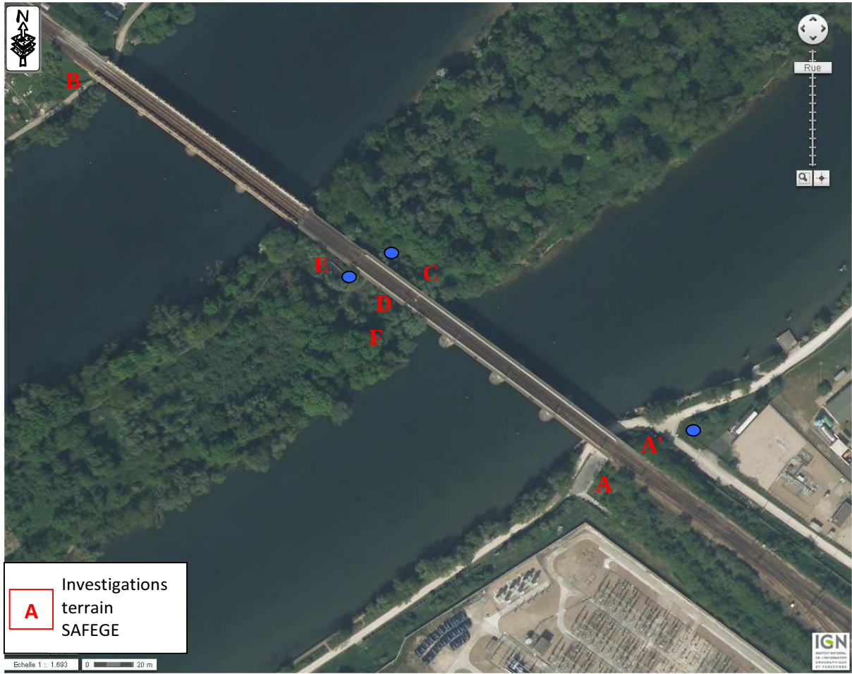
Figure 76 : Localisation des prospections terrain réalisées par SAFEGE (2014, points A à F) et des sondages pédologiques réalisés par EGIS témoins de l’absence d’hydromorphie (2013, points bleus)
