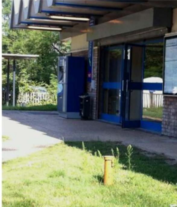
Figure 1 : Piézomètre installé devant le bâtiment voyageur de la gare de Clairières de Verneuil
