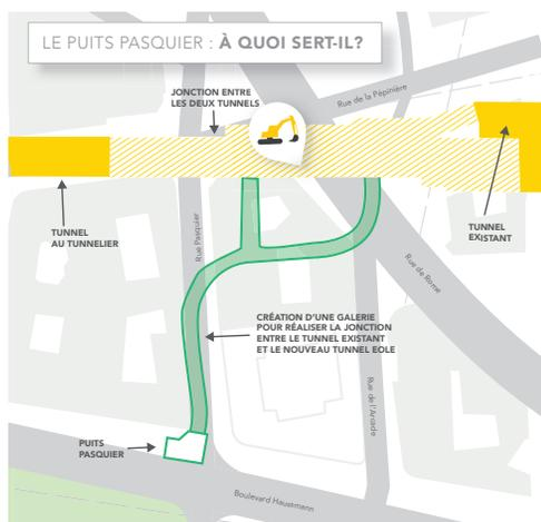
Situé à l'angle du boulevard Haussmann et de la rue Pasquier, le puits dit « Pasquier » va servir à réaliser cet ouvrage de raccordement. Depuis le puits, deux galeries seront creusées sous la chaussée. Elles permettront d'y faire accéder des engins qui creuseront progressivement la jonction entre les deux tunnels. Seuls les déblais de ces travaux sortiront par ce puits. Ceux du tunnel Eole seront quant à eux évacués à Courbevoie.
