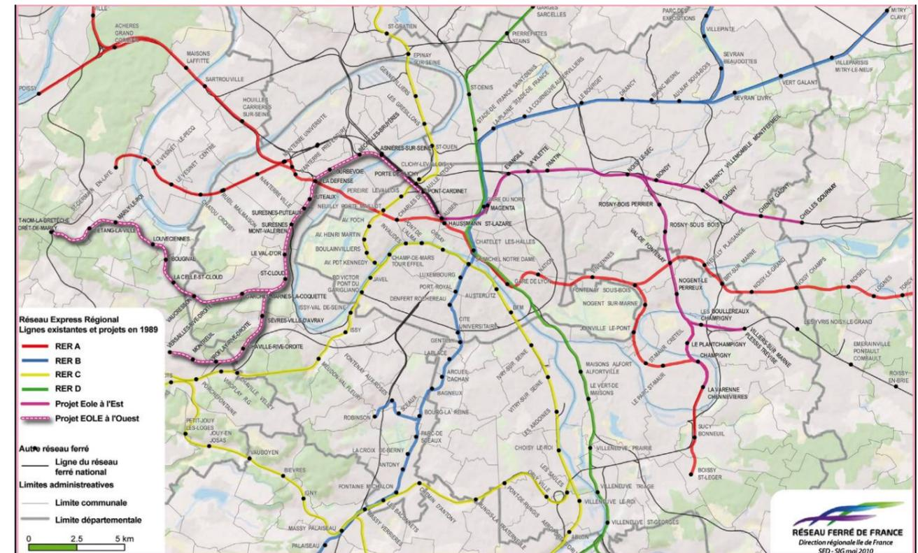
Figure 11 : Tracé du projet EOLE d'après le schéma de principe de 1998
